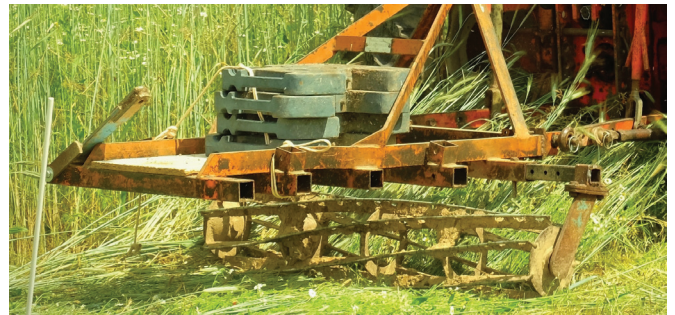
Rouleau « FACA » auto construit à partir d'un rouleau cage
